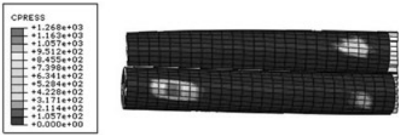
图9 不带倒角节点挤压段索丝接触应力图
